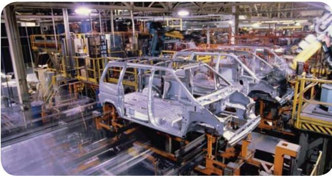
Figure 7 Ce châssis d'automobile est une structure combinée de deux composantes : à coque et à ossature.
